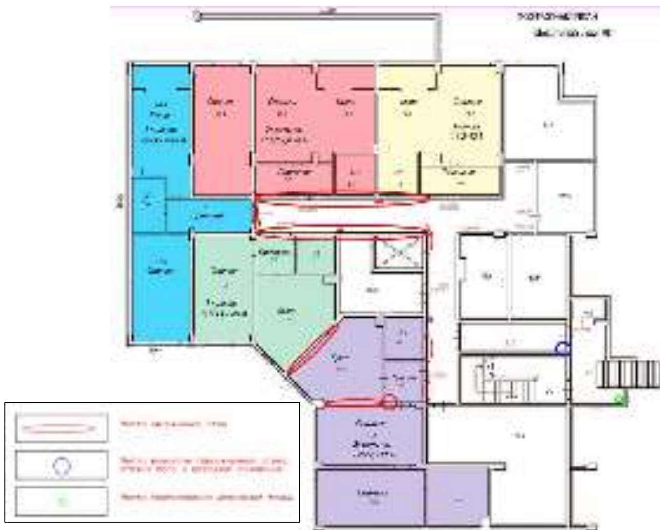
Рисунок 6 – Схема локализации намокания стен корпусе №5.
